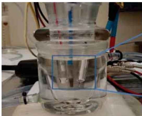
FIGURA 1. Celula electrochimică utilizată în cadrul testelor
