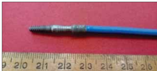
FIGURA 2. Imagine a implantului dentar pregătit pentru testele electrochimice
